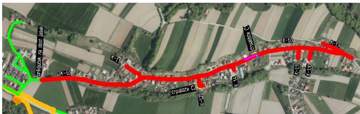
Slika 5: predvidene ureditve javne kanalizacije (rdeče – predvideno, ostalo – obstoječe)
